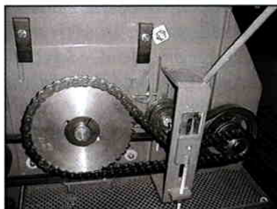
Mekanisk kniv- og snegltræk for BB420/510 standard
