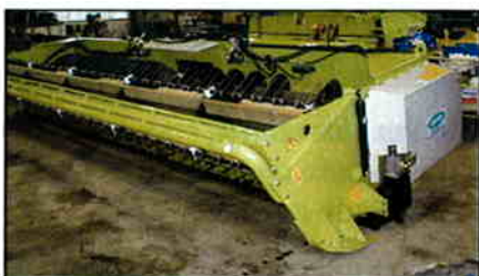
Champion skærebord 6.1 m. Busatis Bidux hydraulisk til Claas Serie 8/9. Reel hydraulisk op og ned (ekstraudstyr).
