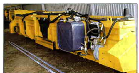
Champion skærebord 6,1m Busatis Bidux med Hydraulisk Power Pack 60L/mm
